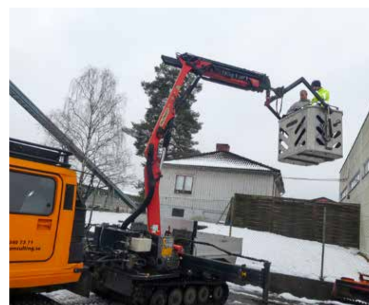
Bandvagnarna kan även byggas på och bestyckas med olika arbetsredskap, bland annat lyftkranar.
